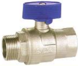
PN16 KÜRESEL VALF İÇXDİŞ VİDA (KELEBEK VOLANLI) Sıcaklık: -35°C, +80°C Uygunluk: TS EN Su, Yağ, Yanıcı Olmayan Gazlar Kumulu, Nispetli Pirinç EN 12148
