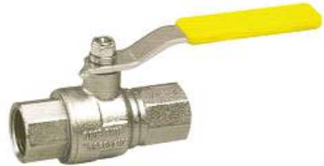
PN5 DOĞALGAZ KÜRESEL VALFİ Sıcaklık: -40°C, +120°C Uygunluk: TS EN 333 Yanıcı Gazlar Kumulu, Nispetli Pirinç EN 12148
