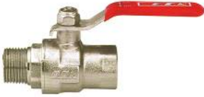
PN16 KÜRESEL VALF İÇXDİŞ VİDA (Tam Geçişli) Sıcaklık: -30°C, +80°C Uygunluk: TS EN Su, Yağ, Yanıcı Olmayan Gazlar Kumulu, Nispetli Pirinç EN 12148
